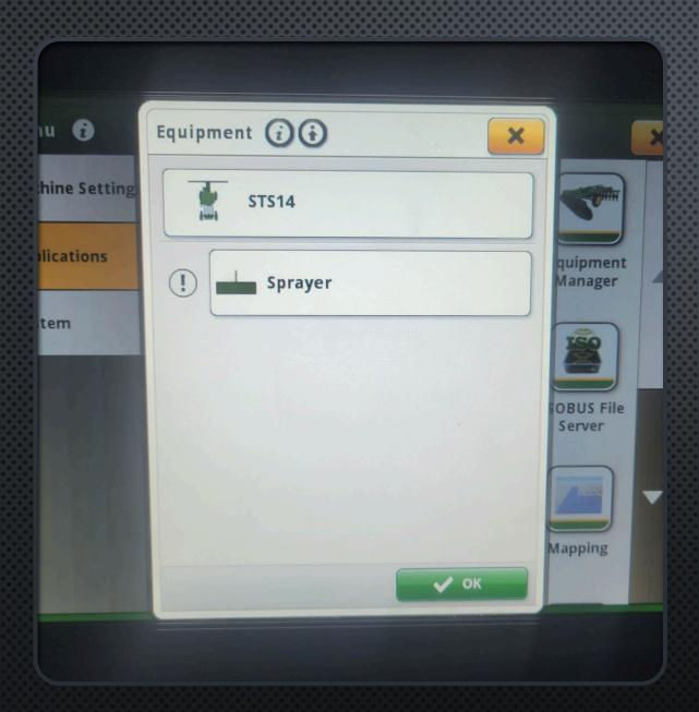
AFTER START-UP AND OBJECT POOL DOWNLOAD, THE JD 4640 SHOULD AUTOMATICALLY POP UP A NEW SPRAYER CONFIGURATION
